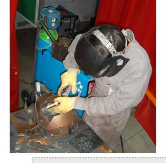
Réalisation du tronc de l'arbre en lamelles d'acier S 235 épaisseur 1,5mm. Pointage des lamelles avec procédé de soudage MAG.
