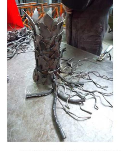
Assemblage par soudage procédé MAG des racines avec le tronc.
